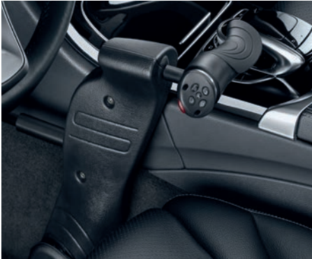
Multima®3 mit MFD1 Einbausituation
